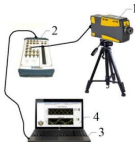
Рис. 5. Схема лазерного комплекса: 1 – лазерный виброметр; 2 – многофункциональный модуль ввода-вывода; 3 – персональный компьютер; 4 – программное обеспечение Fig. 5. Laser system diagram: 1 – laser vibrometer; 2 – multifunctional input/output module; 3 – personal computer; 4 – software
