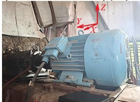
Рис. 1. Направления измерения вибрации относительно положения электродвигателя привода дымососа ДН-21ГМ Fig. 1. Directions of vibration measurement relative to the position of the electric motor of the DN-21GM smoke pump drive
