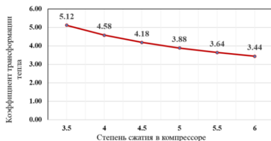
Рис. 5. Зависимость коэффициента трансформации тепла от степени сжатия в компрессоре Fig. 5. Dependence of the heat transformation coefficient on the compression ratio in the compressor
