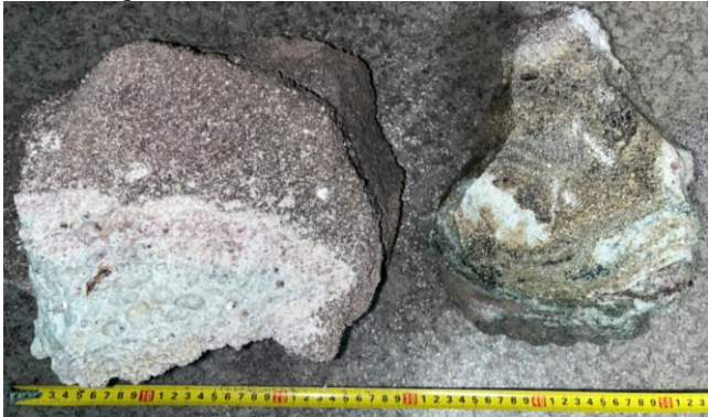
Рис. 4. Агломераты, отобранные после останова котельного агрегата
