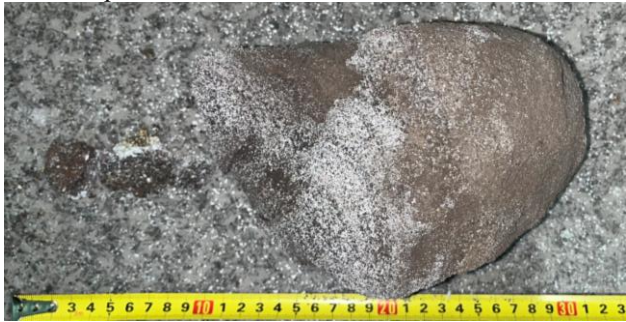
Рис. 3. Агломераты, отобранные на 11 неделе эксплуатации кипящего слоя
