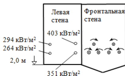
Рис. 6. Значения интенсивностей излучения факела E(\text{кВт}/\text{м}^2) , измеренные с помощью радиометра ТЕРА-50 через смотровые лючки в стене топки для котла ТГМ-84Б при сжигании мазута с разрежением при паровой нагрузке 420 т/ч
