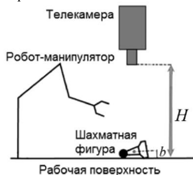
Рис.4. Определение аппликаты места захвата Fig. 4. Determination of the Z-coordinate of the grasp point
