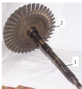
Рис. 2. Вал ротора турбокомпрессора с диском: 1 - вал; 2 - диск с лопатками
