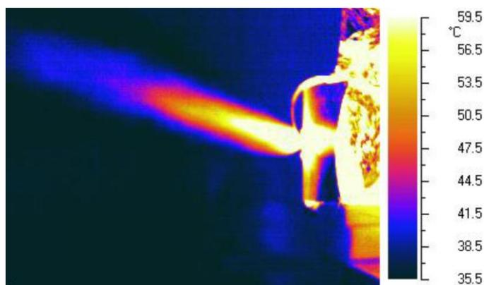
Рис. 7. Термограмма истечения воды через насадок с выходным отверстием со срезом  $\alpha = 45^\circ$ , температура воды  $150^\circ\text{C}$ , давление 5 бар
