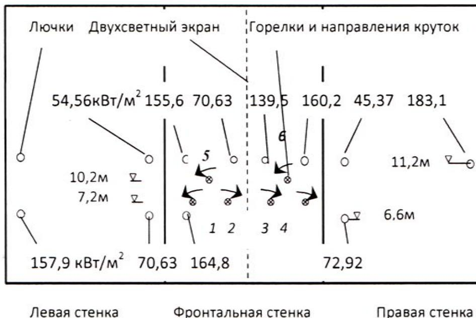
Рис. 3. Тепловые потоки от факела в топке котла ТГМ-84Б (станционный № 10) во время экспериментов на Казанской ТЭЦ-1 при нагрузке 240 т/ч и расходе газа 18600 м<sup>3</sup>/ч (температура входящих газов 129°C, коэффициент избытка воздуха 1,095)
