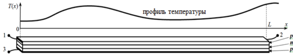
Рис. 1. Устройство полупроводникового одномерного распределенного датчика
