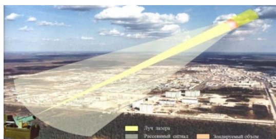
Рис. 1. Принцип экологического мониторинга промышленной зоны методом лазерного зондирования
