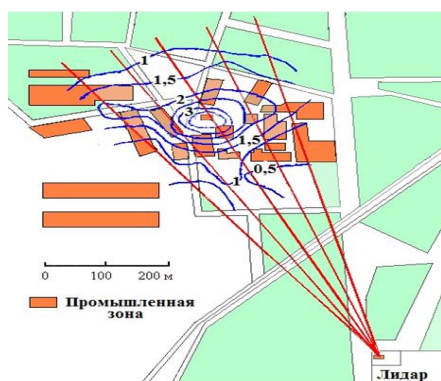
Рис. 9. Лидарное картографирование распределения концентрации загрязнений над территорией предприятия
