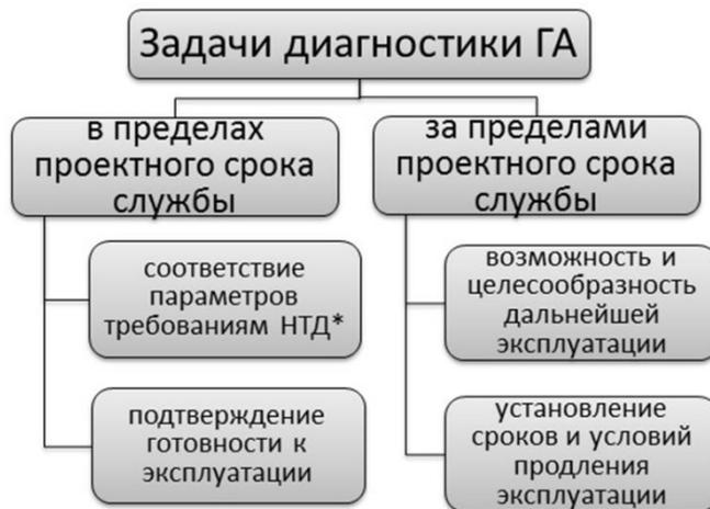
Рис. 1. Задачи диагностики на различных стадиях жизненного цикла
