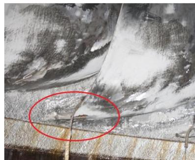
г) дефект в зоне приварки лопасти к ободу РО гидротурбины
