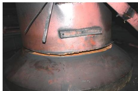
б) трещина в зоне конического перехода вала радиально-осевой гидротурбины
