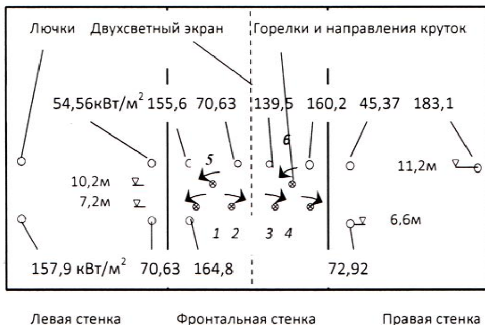
Рис. 3. Тепловые потоки от факела в топке котла ТГМ-84Б (станционный № 10) во время экспериментов на Казанской ТЭЦ-1 при нагрузке 240 т/ч и расходе газа 18600 м 3 /ч (температура уходящих газов 129°C, коэффициент избытка воздуха 1,095)
