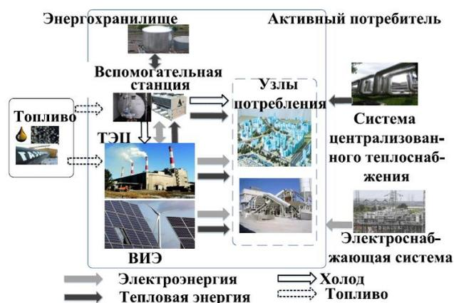
Рис. 1. Обобщенная структура энергосистемы АП
