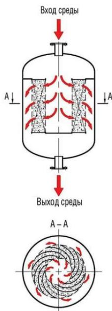
Рис. 4. Схема реактора нового поколения (адиабатические условия)
