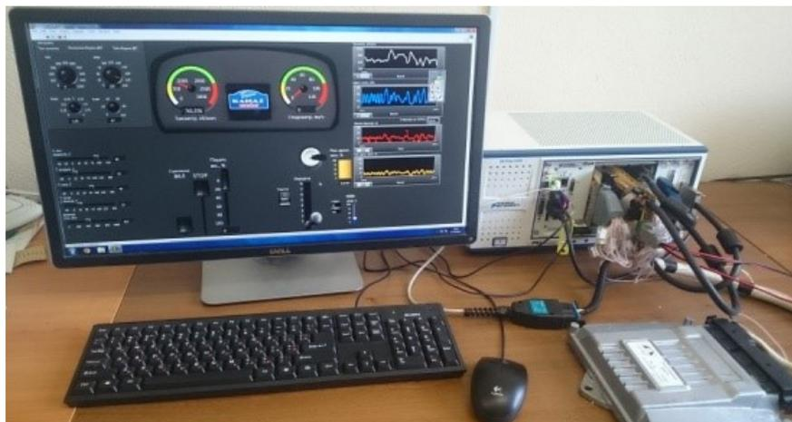
Рис.2. Внешний вид аппаратно-программного комплекса эмуляции работы ЭБУ и газового ДВС
