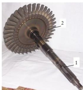
Рис. 2. Вал ротора турбокомпрессора с диском:
