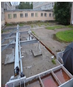
Рис. 6. Испытание опоры ОГК-7 на стенде ИС-1
