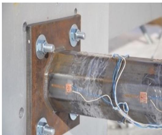
Рис. 5. Установка тензодатчиков на опоре
