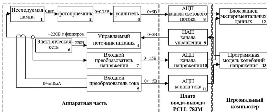
Рис. 7. Блок-схема аппаратно-программного комплекса
