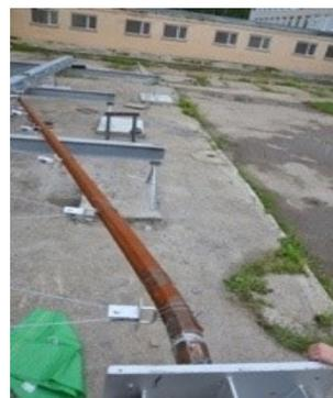
Рис. 7. Опора ОГК-7 после испытания
