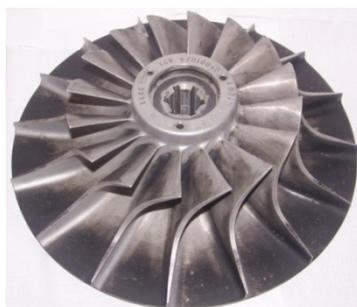
Рис. 3. Крыльчатка компрессора
