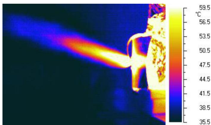
Рис. 7. Термограмма истечения воды через насадок с выходным отверстием со срезом \alpha = 45^\circ , температура воды 150^\circ\text{C} , давление 5 бар
