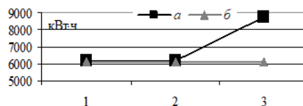
Рис. 10. Сравнение суммарных недельных потерь энергии в распределительной сети: а – для двух вариантов с постоянной конфигурацией 1-2 и при отсутствии реконфигурации – 3; б – при оптимальной часовой реконфигурации
