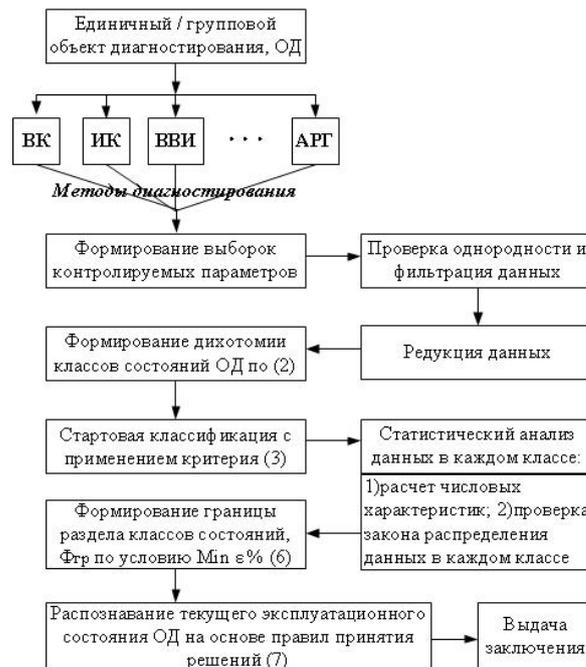
Рис. 3. Алгоритм статистических вычислений и оценки состояния ОД (ВК – вибрационный контроль; ИК – инфракрасный контроль; ВВИ – высоковольтные испытания; АРГ – анализ растворенных газов)
