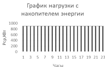
Рис.4. График нагрузки предприятия с накопителем энергии в распределительной сети
