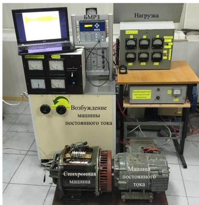
Рис. 5. Лабораторная установка для исследования работы СГ
