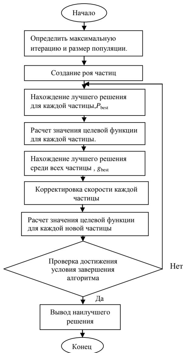
Рис.4 Блок схема метод РЧ
