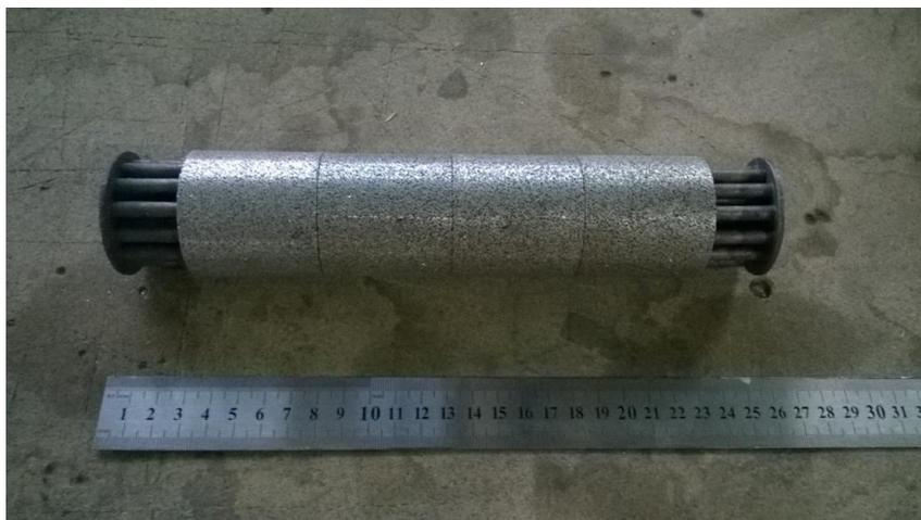
Рис. 1. Вставки из пористого алюминия
