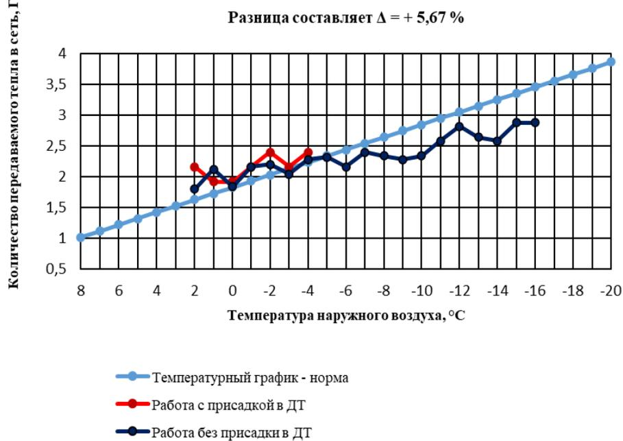
Таким образом, в результате прямого сравнения показателей работы котельной до и после обработки дизельного топлива «Очистителем форсунок котлов «Супротек» получена экономия расхода дизельного топлива – 8,67 %.
