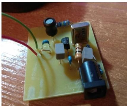
Рис. 11. Кварцевый генератор на 6,5 МГц после сборки
