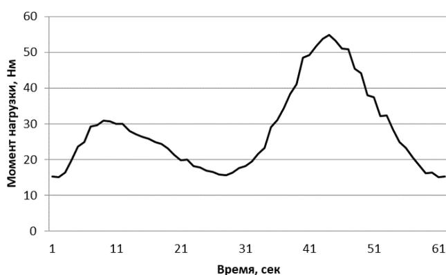
Рис. 6. Момент нагрузки на валу испытываемого двигателя, полученный датчиком момента М40 за один цикл качания
