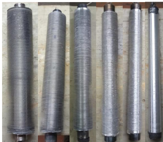
Рис. 1. Образцы экспериментальных труб типов I–VI для однорядных пучков
