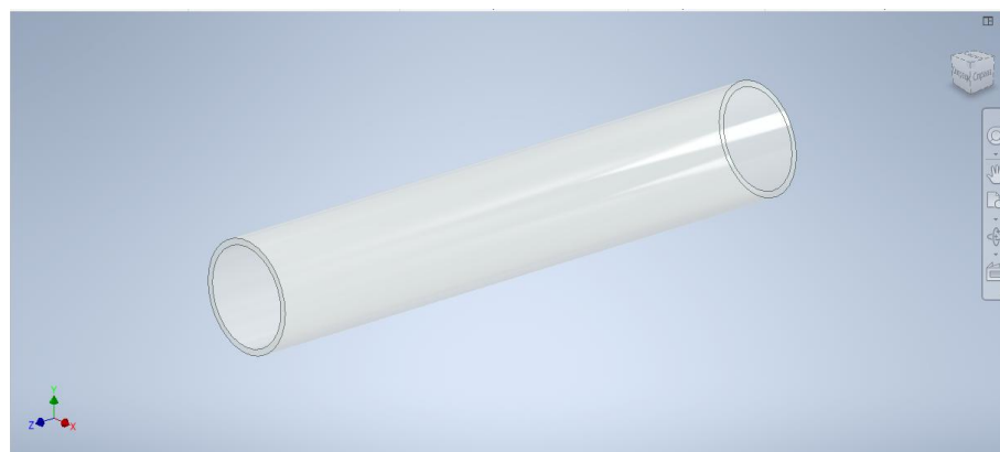
Рис. 4. 3D-модель трубопровода из стеклопластика размерами 400х72х6
