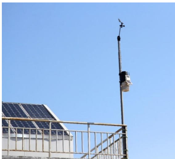
Рис. 4. Метеорологическая станция марки Davis Vantage Pro2 Plus установленная в самостоятельно энергоснабжающем испытательном доме Государственного энергетического института Туркменистана (ГЭИТ)
