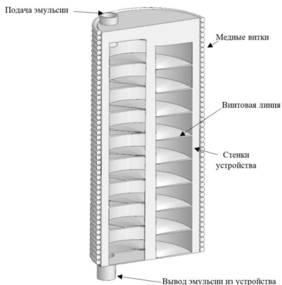
Рис. 1 устройство для обработки нефти в постоянном магнитном поле
