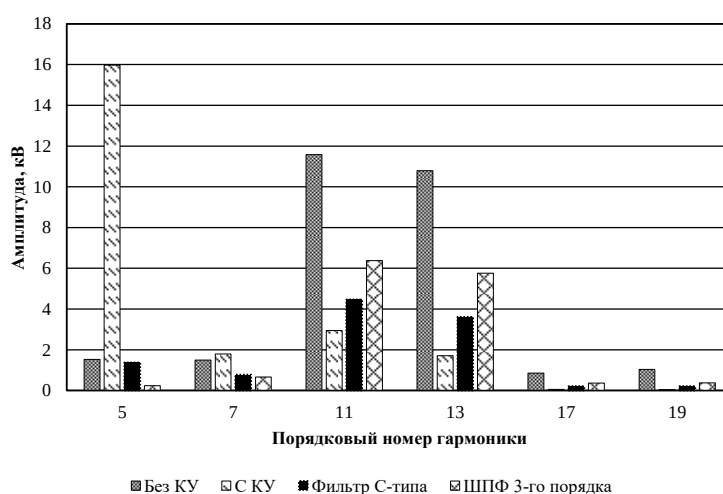
Рис. 8. Спектры напряжения на шинах подстанции (варианты компенсирующих устройств 1-4)
