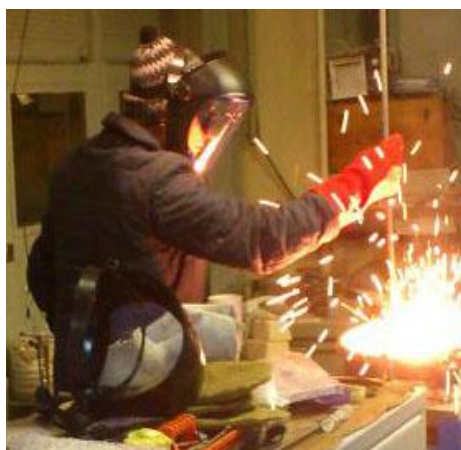
Рис. 3. Установка по плазменно-расплавной переработке отходов и отбор пробы металла из расплава
