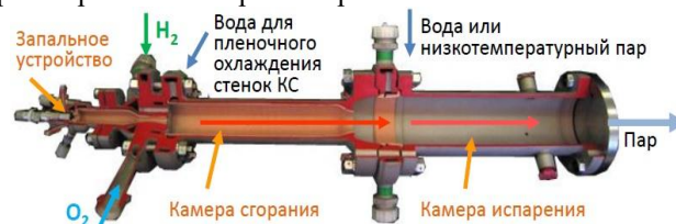
Рис. 1. Конструктивная схема экспериментального образца водородно-кислородного парогенератора Fig. 1. Design diagram of an experimental sample of a hydrogen-oxygen steam generator
