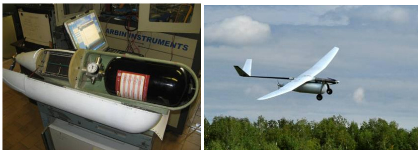
Рис. 14. Беспилотный летательный аппарат с силовой установкой на базе водородных топливных элементов мощностью 250 Вт
