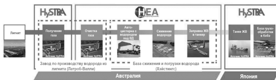
Рис.5. Пилотная водородная энергетическая цепочка японско-австралийского проекта Fig.5. Pilot hydrogen energy chain of the Japanese-Australian project
