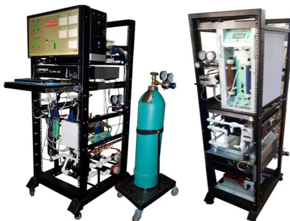
Рис. 5. Общий вид энергоустановок: слева - «H 2 Bio», справа - «H 2 Smart». Fig. 5. General view of power plants: on the left - "H 2 Bio", on the right - "H 2 Smart".
