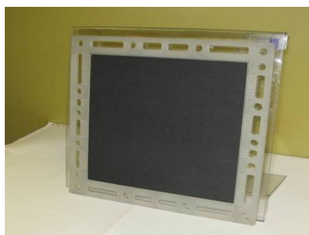
Рис. 11. Интегрированный семислойный мембранно-электродный блок
