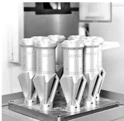
Рис.4. Модифицированные горелки для сжигания водорода на газовых турбинах SGT-600 компании Siemens
