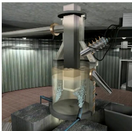
Рис. 3. Установка по плазменно-расплавной переработке отходов и отбор пробы металла из расплава
