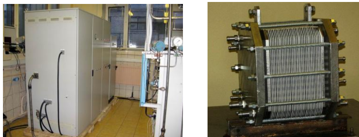
Рис. 12. Энергоустановка на основе топливных элементов с ТПЭ мощностью 10 кВт
