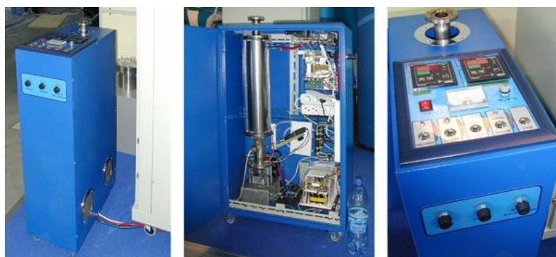
Рис. 2. Фотографии демонстрационного образца плазменного риформера метана Fig. 2. Photos of a demonstration sample of a methane plasma reformer
