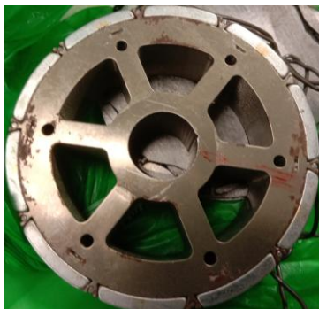
Рис. 5. Ротор СДПМ с поверхностными магнитами
