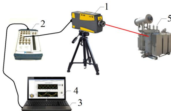
Рис. 2. Схема ЛКИК: 1 – лазерный виброметр PDV - 100; 2 – АЦП NI USB – 6251; 3 – персональный компьютер; 4 – программное обеспечение LabVIEW; 5 – силовой трансформатор
