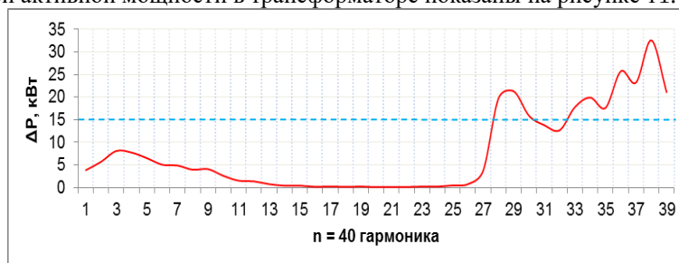
Рис.11. Дополнительные потери активной мощности за счет высших гармоник в трансформаторе
