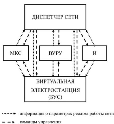
Рис. 2. Структурная схема управления конфигурацией электрической сети, представленной на рис. 1
