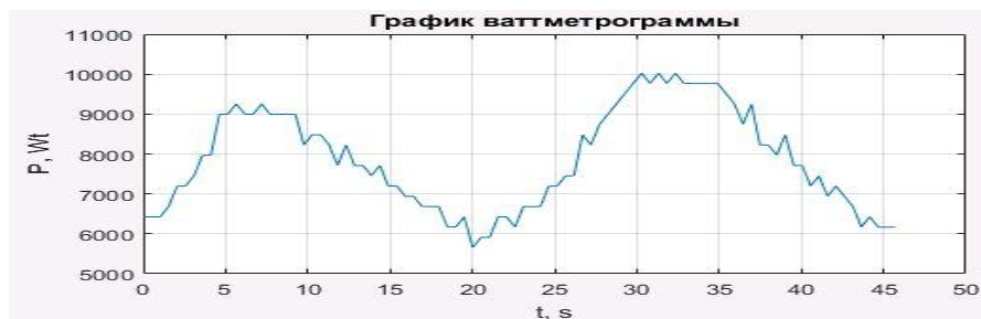
Рис. 9. Ваттметрограмма с действующей ШСНУ
