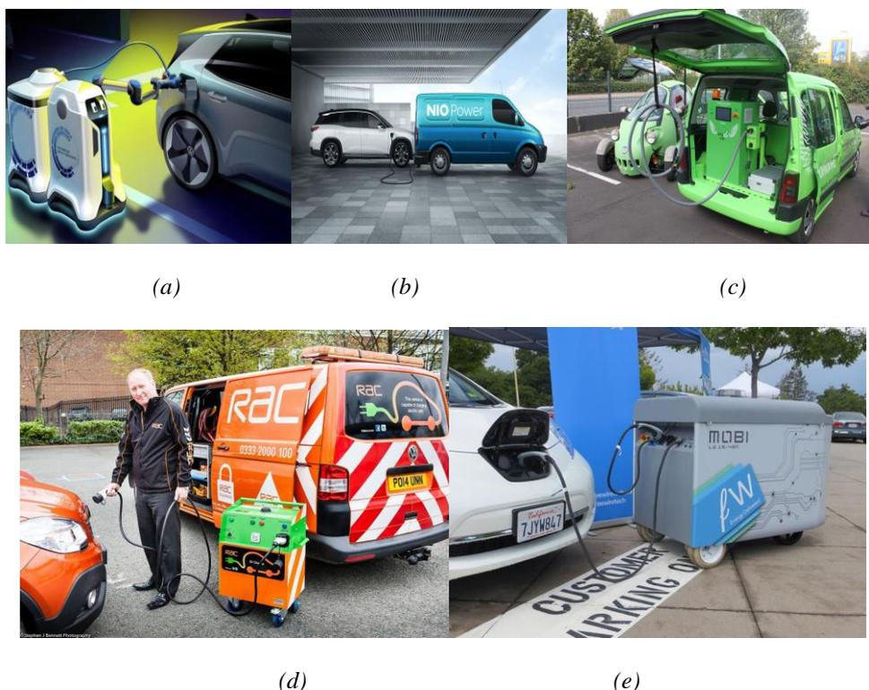
Рис. 4 Мобильные зарядные станции компаний: *Fig.4 Mobile charging stations of companies: a) Volkswagen, b) NIO, c) Eltreco, d) RAC, e) Mobi*
