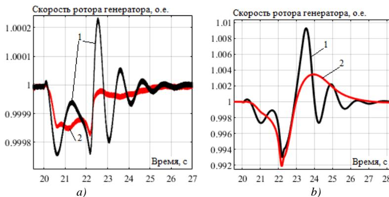
Рис.7. Временные зависимости скорости вращения ротора генератора ТГУ при пуске мощного эквивалентного АЭД: а) – полная схема ИСЭС (НЭ включен); б) – НЭ отключен; 1 – у ТГУ использовался классический АРС; 2 – у ТГУ использовался автопрогностический АРС
