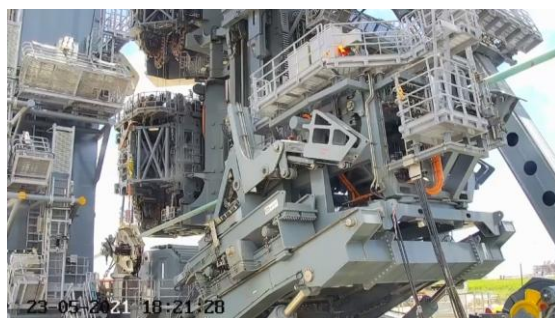
Рис.3. Натяжитель (тензионер) до аварии
