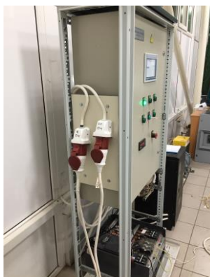
Рис. 5. Розетка переносная ССИ-214 на испытательном стенде Fig. 5. Portable socket SSI-214 on the test bench
