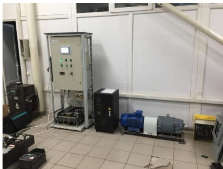
Рис. 3. Общий вид стенда для исследования работоспособности и качества функционирования электротехнических комплексов и систем электроприводов с регуляторами частоты
