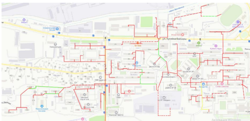
Рис.2. Конфигурация тепловых сетей от котельной «Водник»
