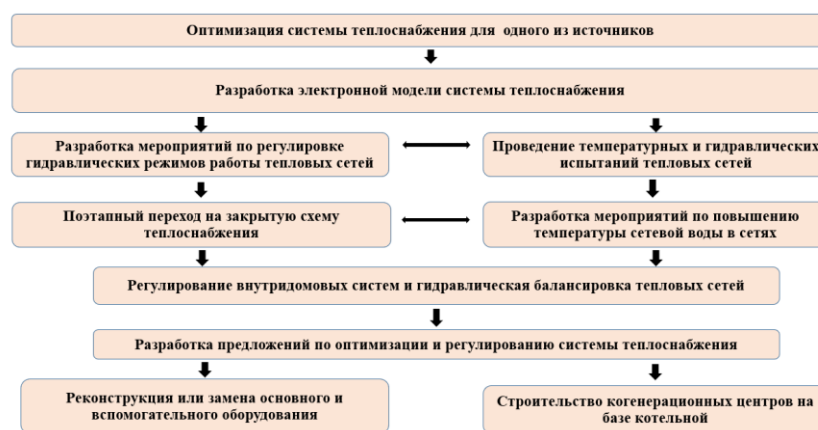
Рис. 4. Производственные предложения по модернизации системы теплоснабжения
