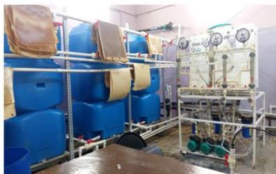
Рис. 5. Устройство и состав оборудования электромембранной установки переработки высокоминерализованных отходов испарительной водоподготовительной установки Казанской ТЭЦ-3.
