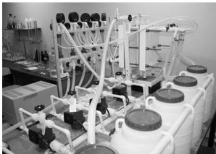
Рис. 3. Лабораторный электромембранный стенд
