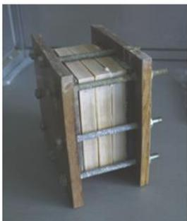
Рис. 2. Лабораторная электромембранная ячейка с тремя камерами
