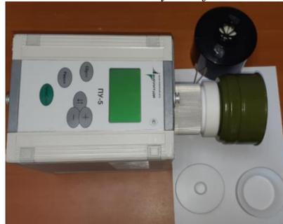
Рис. 6. ПУ-5 в сборе с аналитическим фильтром АФА-РСП20 и ДОТ-600.
