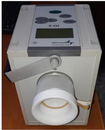
Рис. 5. Отбор проб воздуха непосредственно на аналитический фильтр АФА-РСП20
