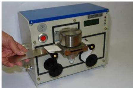
Рис. 1. Установка для измерений объёмной активности радиоактивных аэрозолей.
