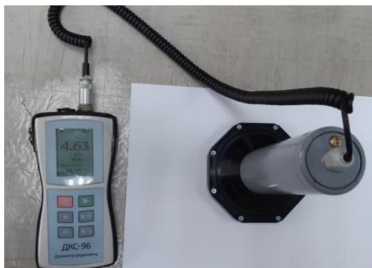
Рис. 3. Измерение альфа-частиц дозиметром радиометром ДКС-96 (блок БДЗА-96) с экспонированного фильтра АФА-РСР20 *Fig. 3. Measurement of alpha particles by a dosimeter with a DKS-96 radiometer (BDZA-96 unit) from an exposed AFA-RSP 20 filter*
