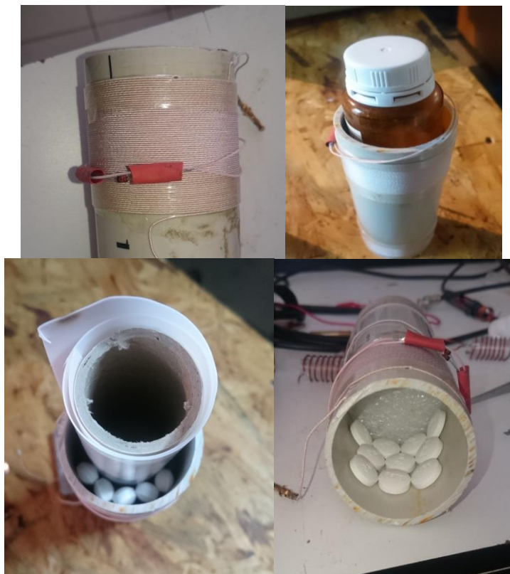
Рис.6 Радиочастотная катушка аппаратно-программного комплекса и размещение исследуемых образцов в катушке.
