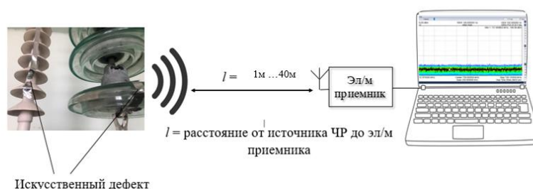
Рис. 7. Схема эксперимента по определению зависимости затухания ЭМ сигнала от расстояния
