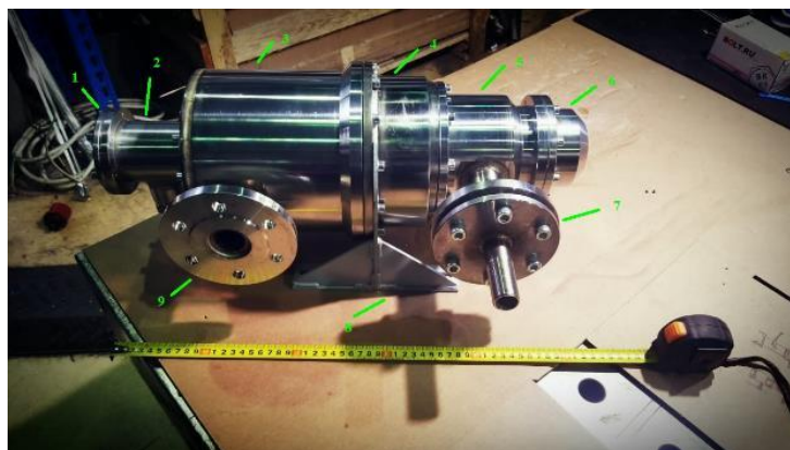
Рис.3. Прототип детандера: 1 - крышка электрической распределительной коробки; 2 - электрическая распределительная коробка; 3 - корпус генератора; 4 - промежуточный корпус (корпус муфты привода); 5 - кожух; 6 - крышка полости шестерен синхронизатора вращения роторов; 7 - входное отверстие труба; 8 - монтажный кронштейн; 9 - выпускная труба.
