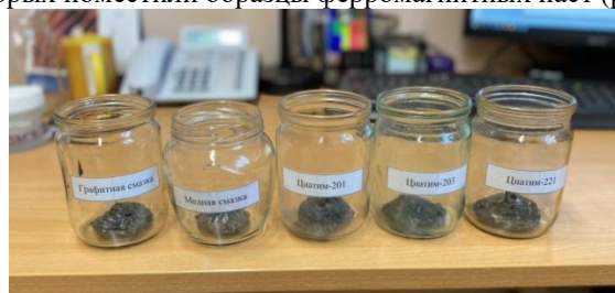
Рис. 5. Фотография подготовленных образцов ферромагнитных паст
