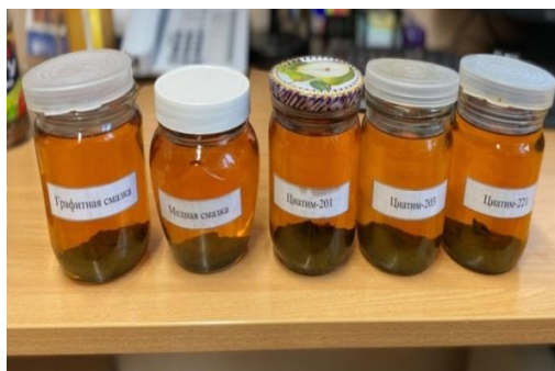
Рис. 6. Фотография подготовленных образцов трансформаторного масла с ферромагнитной пастой
