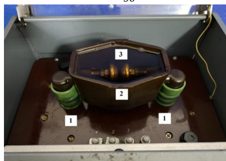
Рис. 4. Внутренние части электроприбора АИМ-90: 1 – опорные изоляторы; 2 – измерительная ячейка; 3 – электроды
