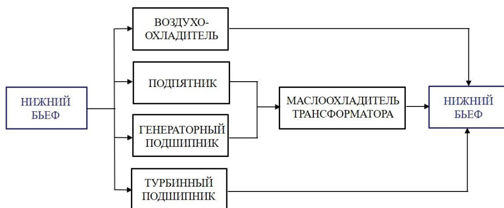
Рис.2. Схема системы охлаждения гидрогенератора
