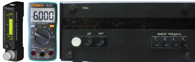
Рис. 2. Измерительные приборы (слева направо): газовый расходомер Mass Flow, мультиметр Richmeters 102, цифровой прибор Ф266
