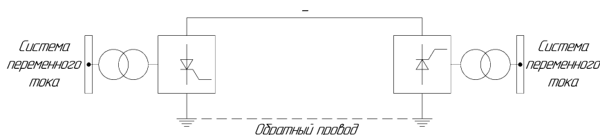
Рис. 15. Однополярная вставка HVDC
