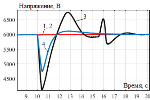
Рис. 4. Напряжение турбогенератора при отключении основного питания: обозначения 1, 2, 3 и 4 аналогичны рис.3
