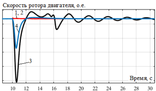
Рис. 5. Изменение скорости ротора двигателя при отключении основного питания: обозначения 1, 2, 3 и 4 аналогичны рис.3
