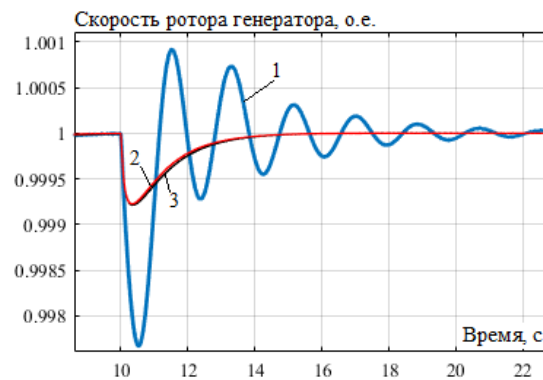
Рис.11. Скорость ротора генератора в режиме подключения дополнительной нагрузки: 1 – без использования НЭ и регуляторы без ПЗ; 2 – без НЭ и с использованием СПАРВ и СПАРЧВ; 3 – использовались НЭ, СПАРВ и СПАРЧВ
