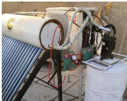
Рис. 5. Наружный блок и солнечный коллектор
