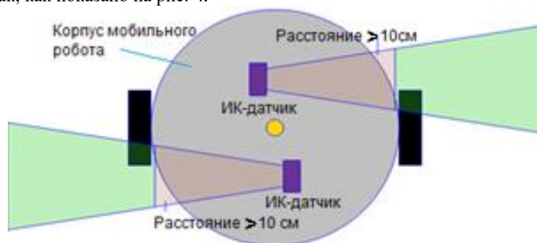
Рис. 4. Пример установки ИК-датчиков на Fig. 4. An example of installing IR sensors on the корпусе МР MR body
