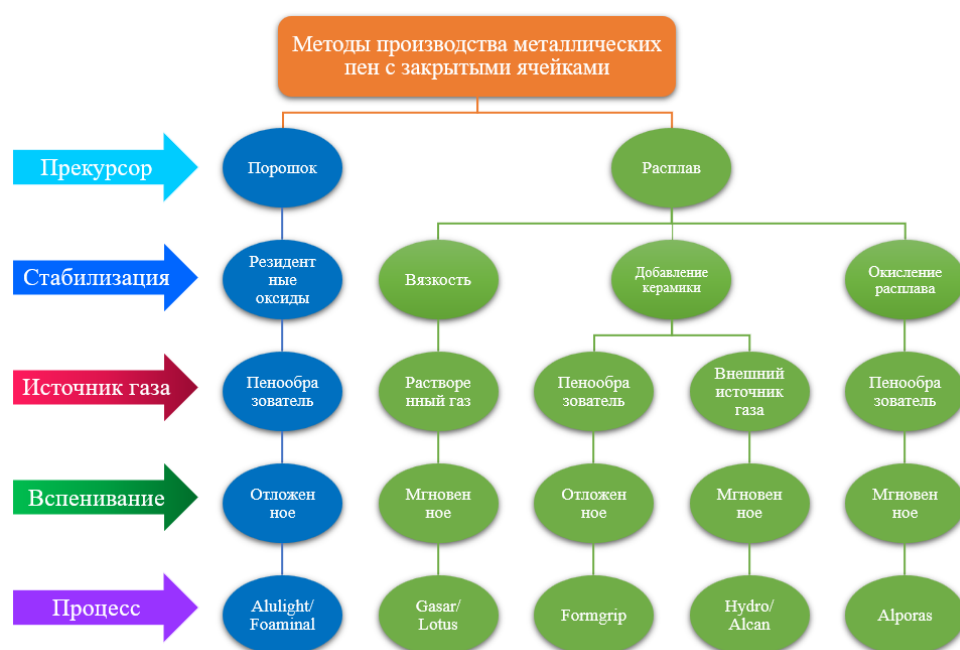
Рис. 2. Методы производства металлических пен с закрытой ячейкой [14]
