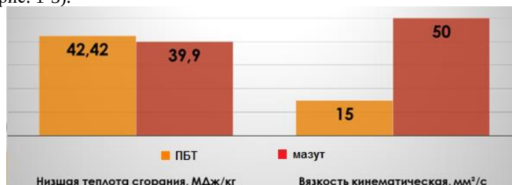
Рис. 1. Низшая теплота сгорания (МДж/кг) и вязкость кинематическая (мм²/с) для мазута и печного бытового топлива
