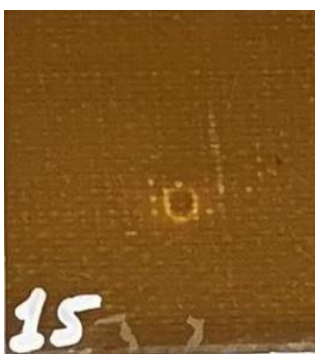
Рис.8. Характер ударных повреждений по фрагменту лопасти в зоне лонжерона при различных энергиях удара
