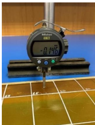
Рис.6. Замер глубины повреждения
