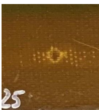
Рис.8. Характер ударных повреждений по фрагменту лопасти в зоне лонжерона при различных энергиях удара
