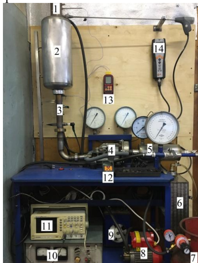
Рис. 3 Общий вид лабораторного стенда: 1 – камера пиролиза; 2 – теплообменник; 3 – камера сгорания; 4 – пульсатор; 5 – камера Эйфеля; 6 – бак с водой; 7 – газовый баллон с редуктором; 8 – водяной насос; 9 – охладитель; 10 – блок питания; 11 – осциллограф; 12 – термоанемометр; 13 – термометр; 14 – газоанализатор
