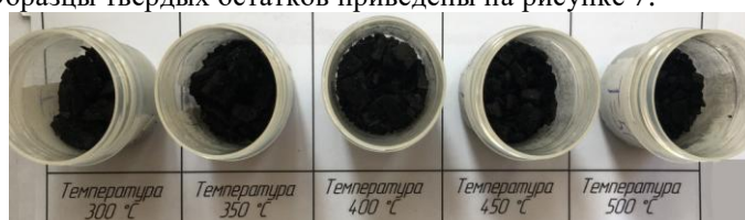
Рис. 7. Образцы твердых остатков после пиролиза резины
