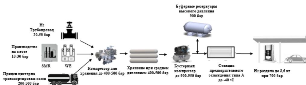
Рис. 3. Схема ВЗС с дожимным дозирующим компрессором (SMR –паровая конверсия метана; WE – электролиз воды)
