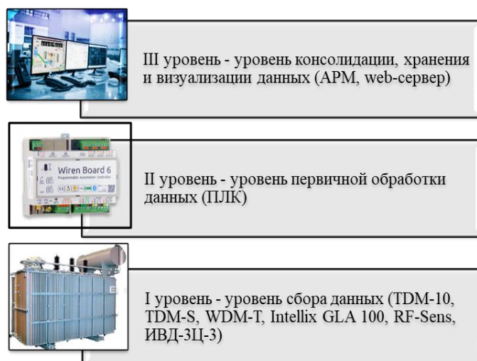
Рис. 1. Система мониторинга силового трансформатора ТМН-6300 35/6(10) кВ Fig.1. Monitoring system for power transformer TMN-6300 35/6(10) kV
