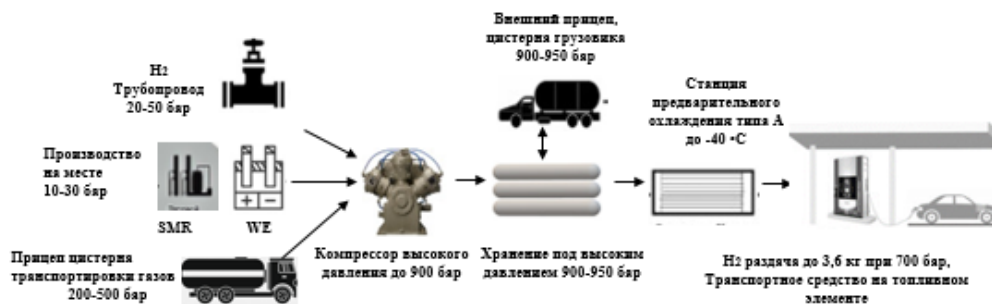
Рис. 2 Схема ВЗС с каскадным процессом заправки (SMR –паровая конверсия метана; WE – электролиз воды)
