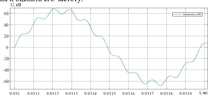
Рис. 8. Напряжение на первом вакуумном выключателе Fig. 8. Voltage at the first vacuum circuit breaker
