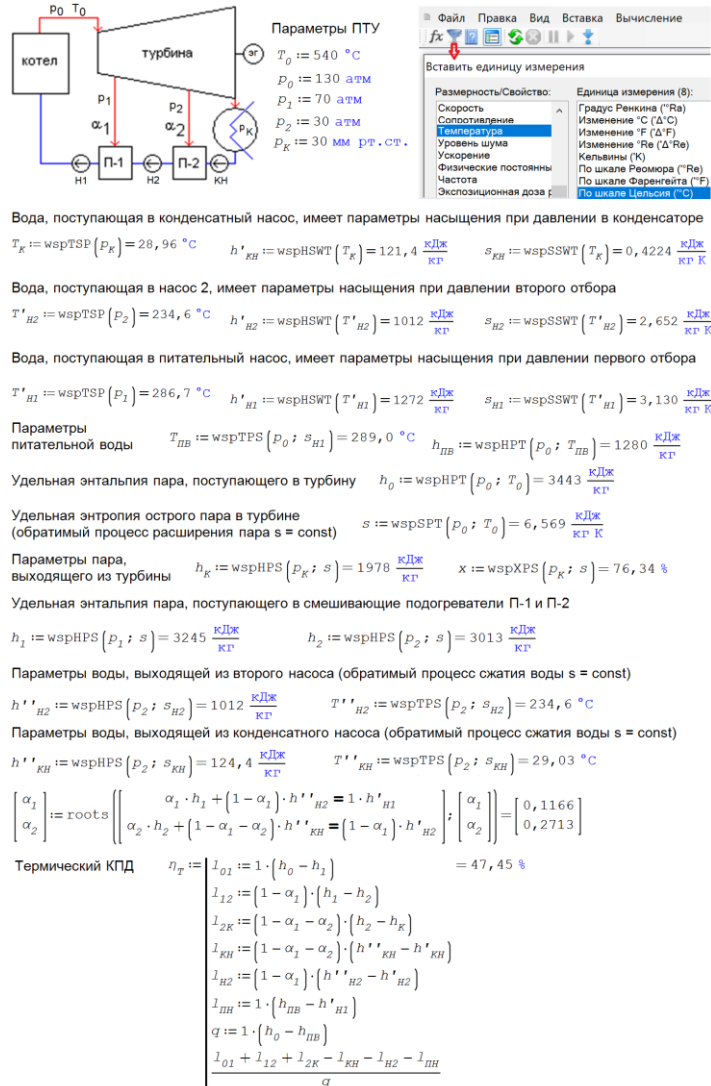
Рис. 7. Расчет термического КПД для модифицированного блока ПТУ, содержащего два регенеративных смешивающих подогревателя
