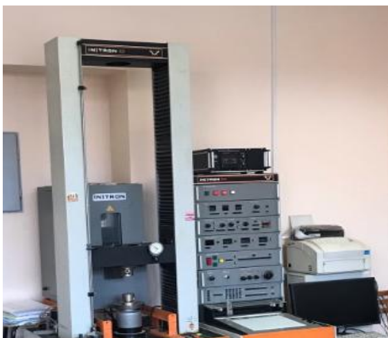
Рис. 4 Лабораторная установка для формирования брикета Instron1121 Fig. 4 Laboratory installation for briquette formation Instron1121
