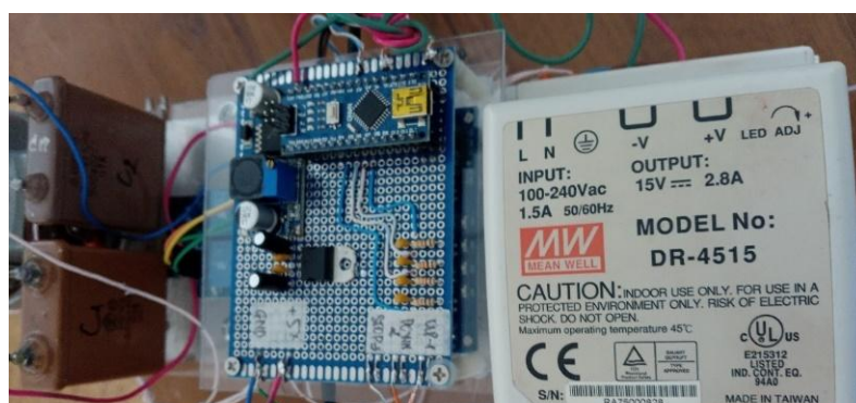
Рис. 9. Преобразователь переменного тока 220 В в постоянный ток 15В
