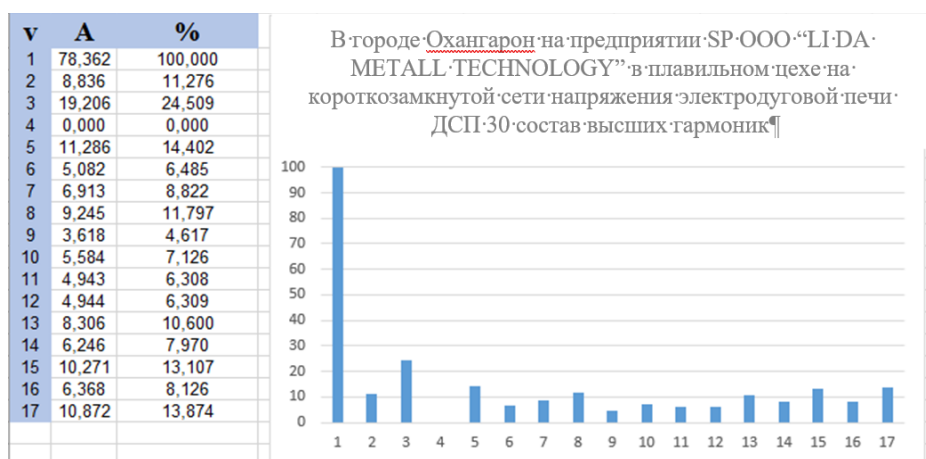
Рис. 4. Гармонический состав и диаграмма высших гармонических в кривой напряжения на короткой сети печи ДСП-30
