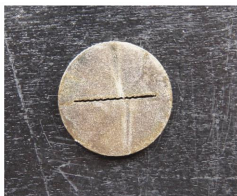
Рис. 5. Диск симуляции дефекта трещина
