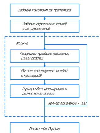
Рис.3. Блок-схема генетического алгоритма \*Источник: составлено автором. \*Source: compiled by the author.
