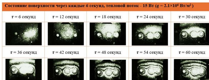
Рис. 11. Голографические интерферограммы покрытия из туфа *Fig. 11. Holographic interferograms of the tuff coating*
