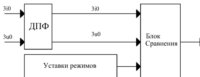
Рис. 14. Структурно-функциональная схема пускового органа защиты на основе токов и напряжений нулевой последовательности
