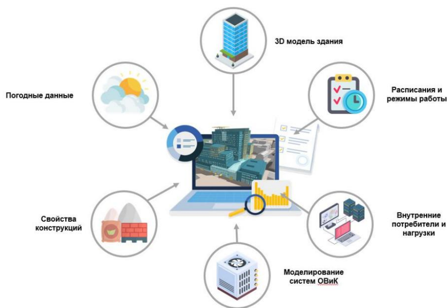
Рис. 1. Основные этапы создания энергетической модели Fig. 1. The main stages of creating an energy model
