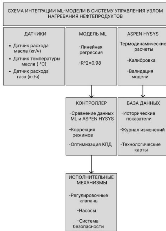
Рис. 8. Схема интеграции ML-модели в систему управления узлом нагрева нефтепродуктов Fig. 8. Integration of an ML model into the control system of a heating unit for petroleum products
