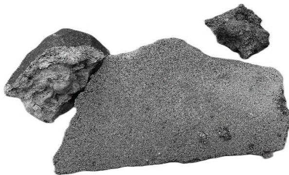
Рис. 2. Агломераты, обнаруженные в донной золе котлоагрегата Е-75-3,9-440 ДФТ Fig. 2. Agglomerates found in the bottom ash of boiler unit E-75-3,9-440 DFT
