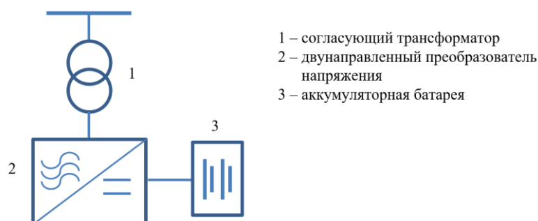
Рис. 3. Принципиальная схема аккумуляторной СНЭЭ Fig. 3. Schematic diagram of a battery energy storage system
