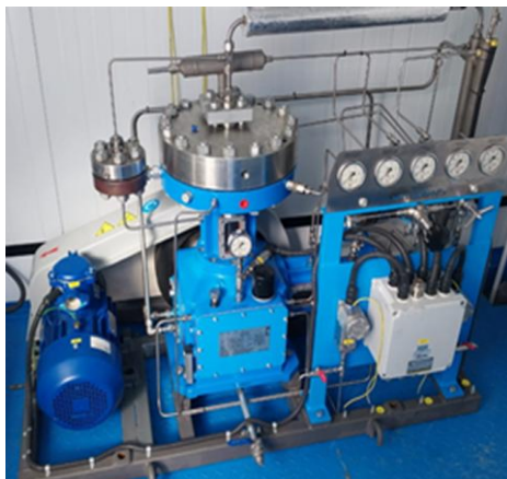
Рис. 10. Мембранный компрессор Ковинт КСВД-М 1-5/5-400-Н 2 Fig. 10. Kovint KSVD-M 1-5/5-400-H 2 diaphragm compressor
