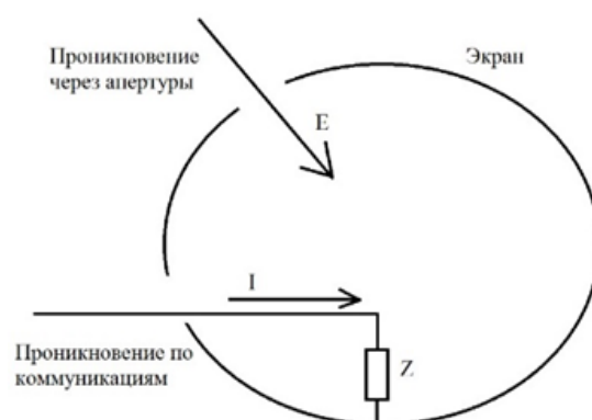
Рис. 2. Неоднородный экран с апертурой и отверстием для коммуникаций
