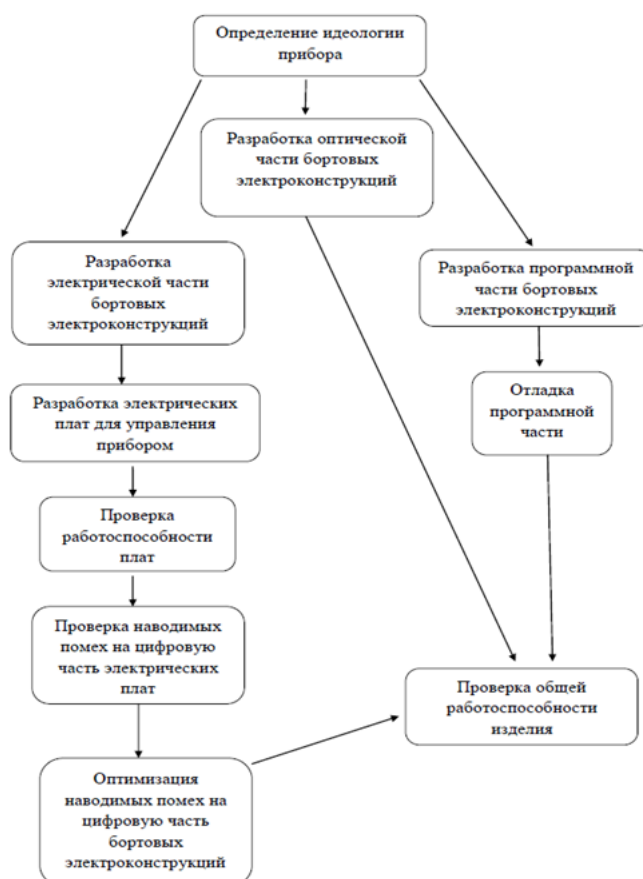
Рис. 1. Проектирование отдельных изделий на борту летательного аппарата
