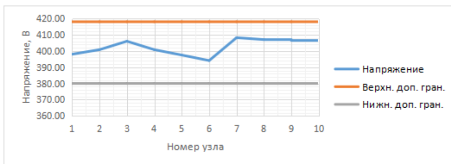
Рис. 11. Напряжения на шинах 0,4 кВ ТП в режиме минимальных нагрузок Fig. 11. Voltages on 0.4 kV TP buses in minimum load mode
