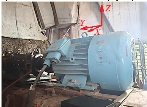
Рис. 1. Направления измерения вибрации относительно положения электродвигателя привода дымососа ДН-21ГМ
