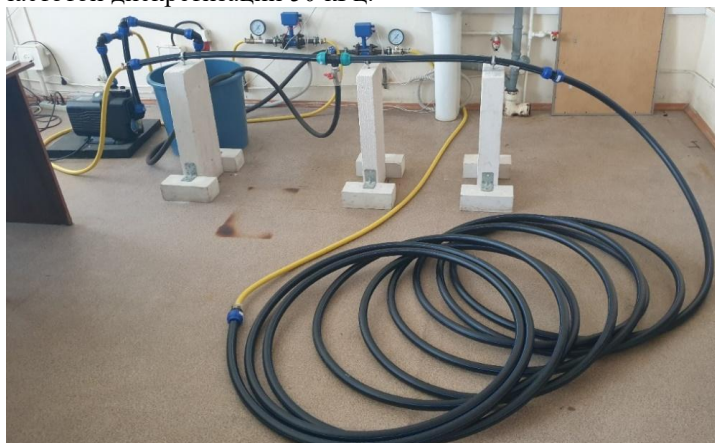
Рис. 2. Экспериментальный стенд с полиэтиленовым трубопроводом Fig. 2. Experimental stand with a polyethylene pipeline
