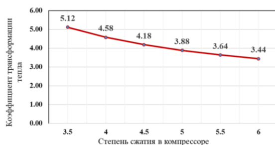
Рис. 5. Зависимость коэффициента преобразования тепла от степени сжатия в компрессоре
