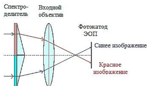
Рис. 3. Ход световых лучей на входе дефектоскопа
